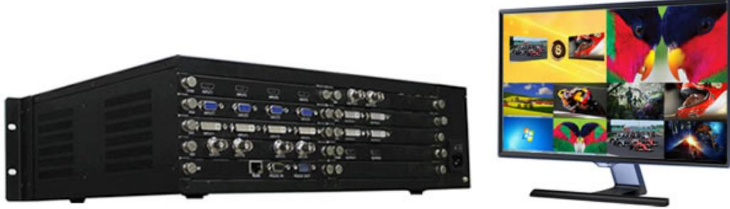
TCF17-16 画面分割器是一款插卡式多格式输入高清十六画面分割器，是采用高性能 FPGA 纯硬件图像处理内核，基于标准工业机箱和热插拔技术设计的高性能图像处理设备。
