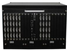
TCF17-MXN 系列矩阵画面分割器是一款插卡式多格式输入输出混合矩阵加高清画面分割器一体机,提供不同规格机箱,实现从4X4-36X36规模,并且可指定任意一个端口4-16画面分割显示,其它端口切换显示。产品采用高性能 FPGA 纯硬件图像处理内核,基于标准工业机箱和热插拔技术设计的高性能图像处理设备。
